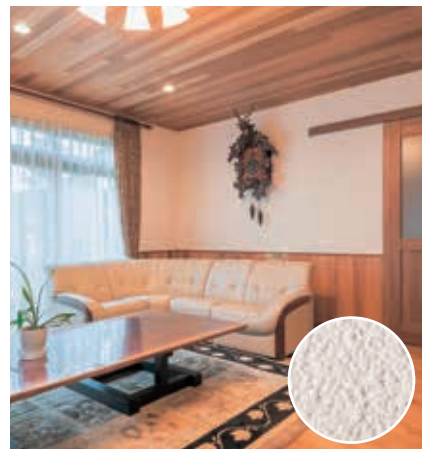
珪藻土 ケイ藻の殻の化石に粘土などがまじった堆積物。耐火性能が高く、断熱性、保温・調湿効果に優れています。自然の陰影がでるため美しく仕上がります。
